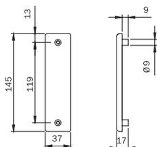
Kit accessori per montaggio su porte a vetro spessore max 12 mm. **PER GRUPPO SERRATURA CENTRALE MANIGLIONE TIPO "A". SENZA COMANDO ESTERNO.**
