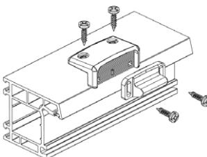
Incontro regolabile per maniglioni antipanico serie **"IDEA Base"** e **"Push"**, chiusura superiore e laterale, verniciato scivolo in zama. Per porta singola o due ante. Adatto per profili con sormonto da mm 14 a mm 24. Viti di fissaggio. Foglio istruzioni.
