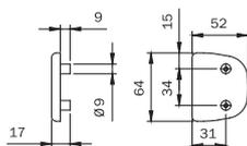
Kit accessori per montaggio su porte a vetro spessore max 12 mm. **PER GRUPPO SERRATURA CENTRALE MANIGLIONE TIPO "B". SENZA COMANDO ESTERNO. REVERSIBILE.**
