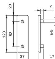
Kit accessori per montaggio su porte a vetro spessore max 12 mm. **PER COPPIA SCROCCHI VERTICALI**
