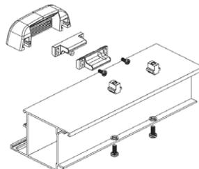
Incontro regolabile per maniglioni antipanico serie **"IDEA Base"** e **"Push"**, chiusura superiore o laterale, verniciato scivolo in zama. Per porta singola o due ante. Adatto per profili complanari e con sormonto fino a mm 11. Viti di fissaggio. Foglio istruzioni.
