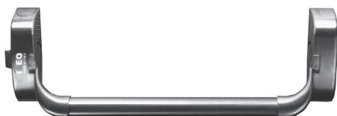
Maniglione antipanico "IDEA Base PVD - Inox" **MODULARE**, reversibile, finitura in PVD - INOX. Predisposto per chiusura laterale, duplice, triplice. **SCROCCO IN ACCIAIO CON AUTOBLOCCANTE**, idoneo per porte TAGLIAFUOCO. Incontri INOX 94100112. Due piastre di fissaggio in INOX 94100042. Predisposto per aggancio aste per alto/basso. Tappi per fori alto/basso. Spessore in nylon per comando esterno. Dima. Istruzioni di montaggio.
