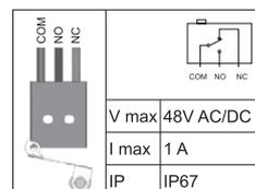
Comando esterno con microswitch per maniglioni antipanico. Tagliafuoco, composto da **MANIGLIA E CILINDRO** in dotazione cod. 820930109\*. Il **MICROINTERRUTTORE** dà il segnale di “Stato maniglia bloccata” ossia “Stato chiuso” e “Stato maniglia libera di ruotare” ossia “Stato aperto”.
