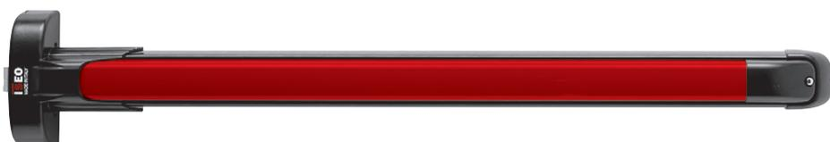
Maniglione antipanico **"Push" MODULARE REVERSIBILE**, predisposto per aggancio aste. Accorciabile fino a mm 330. Scrocco in acciaio con autobloccante, idoneo per porte **TAGLIAFUOCO**. Tappi per fori alto/basso. Incontri a corredo.
